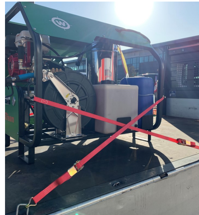
Figure 9 - Exemple de cerclage du L12 à un véhicule
