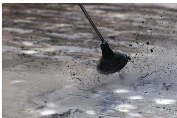
**LANCE À PRESSION :** Cette lance est notre lance haute pression (20 bar). Bien que la pression soit inférieure à celle des solutions conventionnelles à haute pression, Foamstream permet d'obtenir un résultat de traitement plus efficace grâce à sa haute température prolongée délivrée par un matelas de mousse isolante qui réduit les dommages causés aux surfaces.
